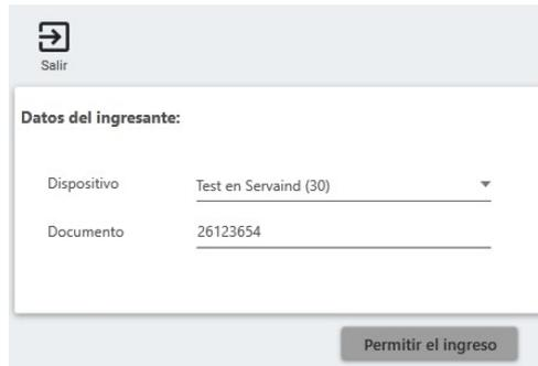
Cargando el DNI del ingresante y presionando el botón "Permitir Ingreso" el sistema envía un comando al MTC-1S seleccionado (si hay más de un dispositivo MTC-1S cargado en el sistema se debe seleccionar el equipo instalado en el ingreso por donde va a acceder el ingresante).
