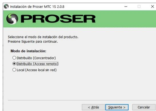
La PC donde se instale un Acceso remoto debe tener conexión por red (local o internet) con el concentrador y debe también tener habilitado el acceso o tráfico de datos por dos puertos TCP (por defecto 5151 y 5152).
